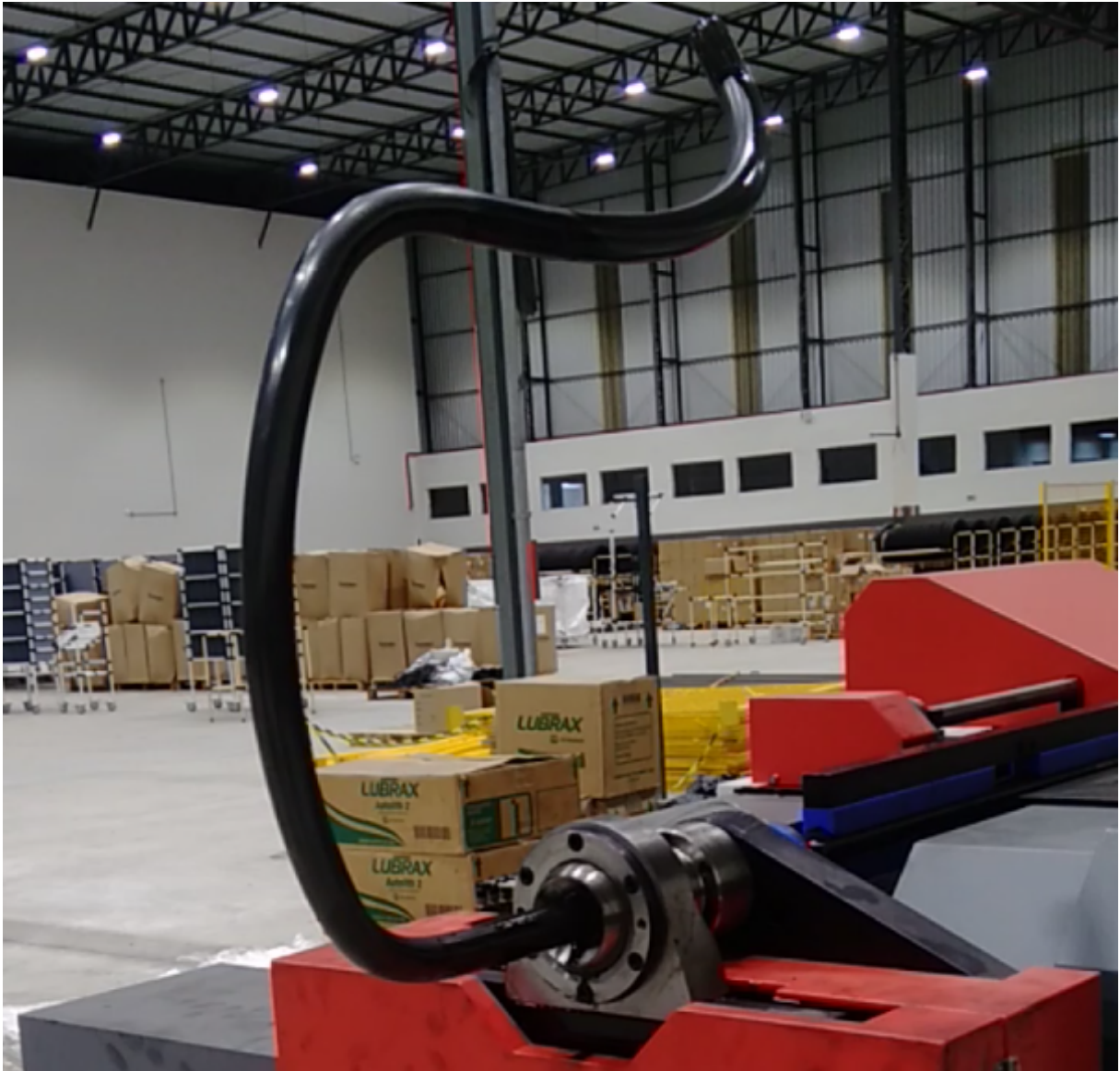
Figura 39 – Máquina dobradeira de tubos operando.
