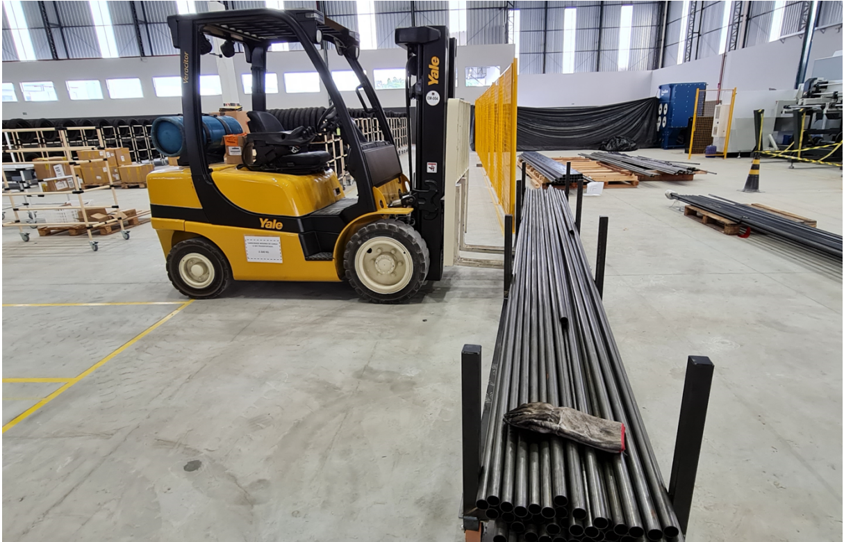
Figura 14 – Movimentação de tubos com utilização de empilhadeira
