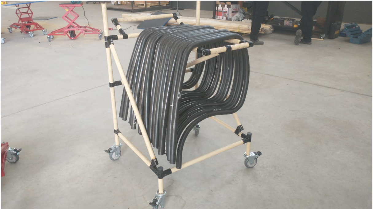
Figura 18 – Carrinho de movimentação de tubos dobrados
