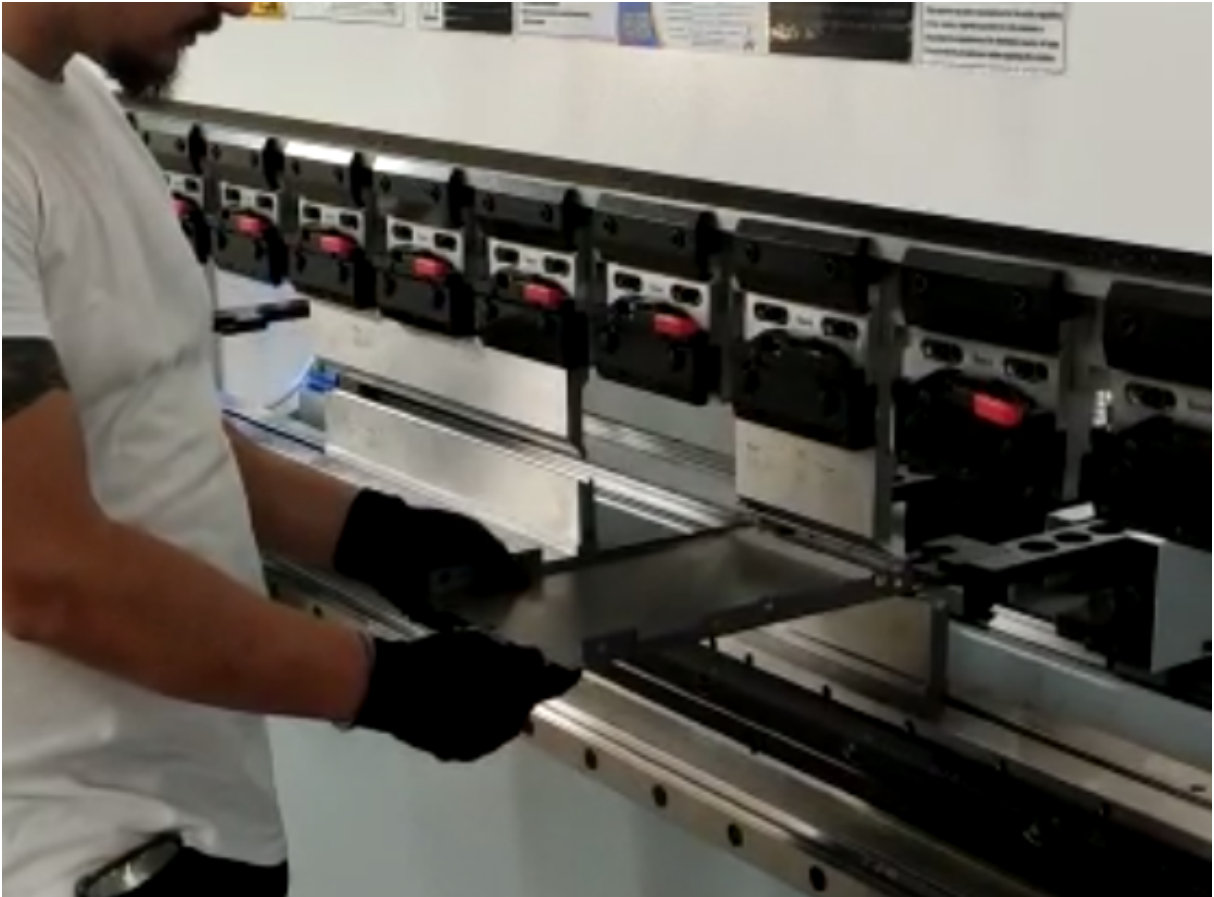
Figura 20 – Peça metálica sendo dobrada na dobradeira de chapas.
