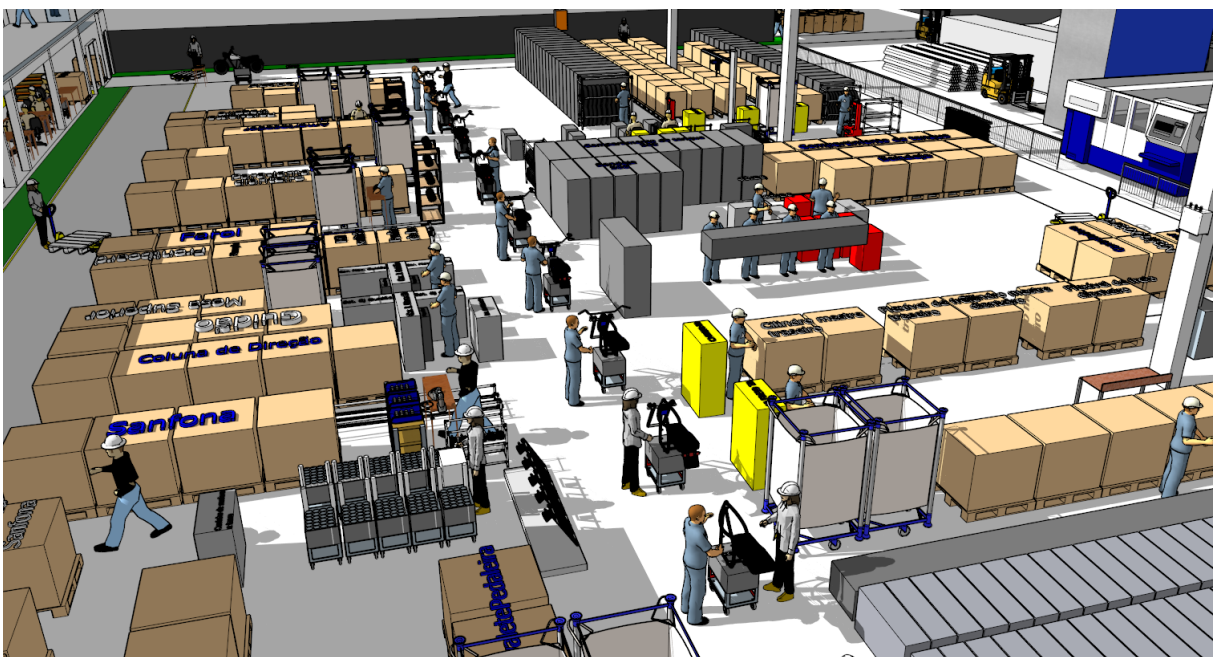
Figura 46 – Fluxo de montagem simplificado da motocicleta.
