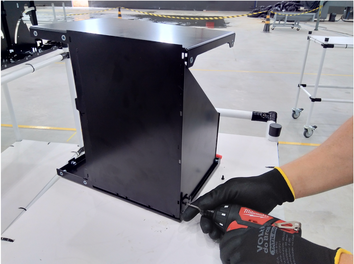
Figura 22 – Montagem da estrutura metálica da Unidade Central.
