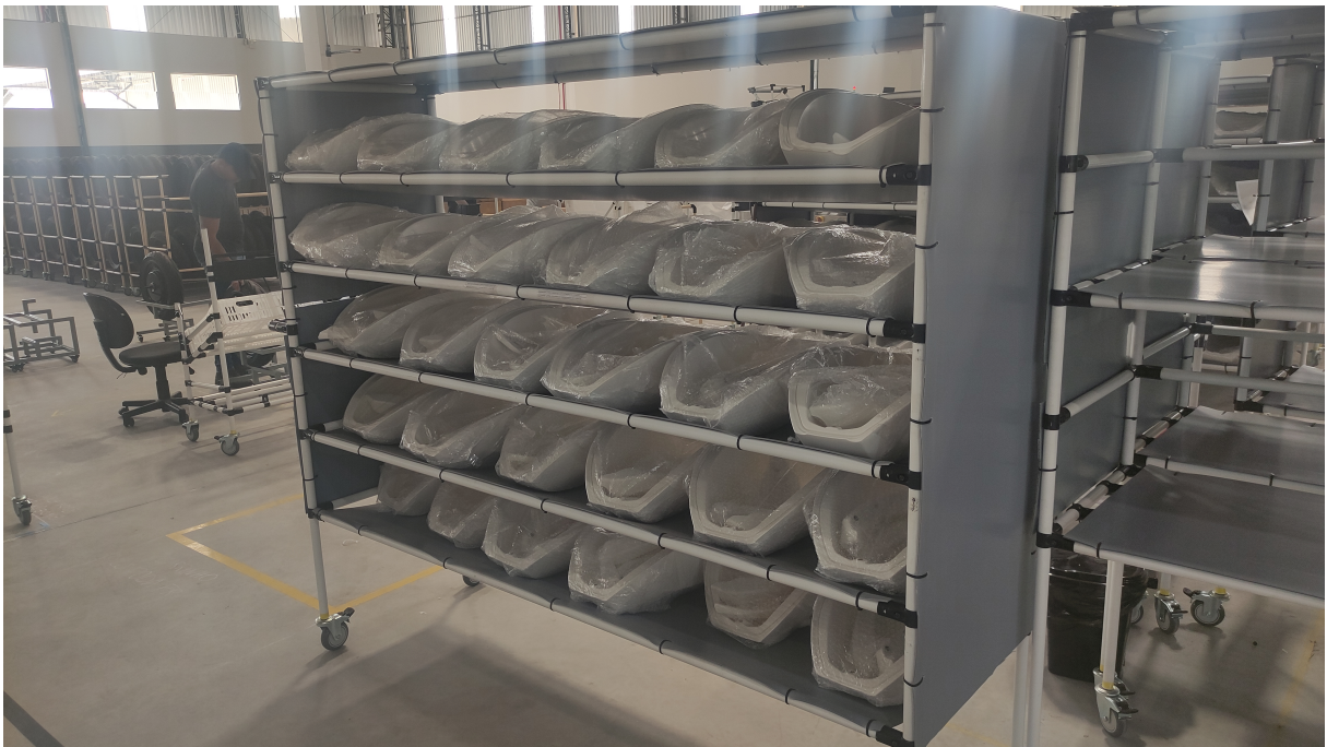
Figura 47 – Estrutura de armazenamento de carenagens da motocicleta.
