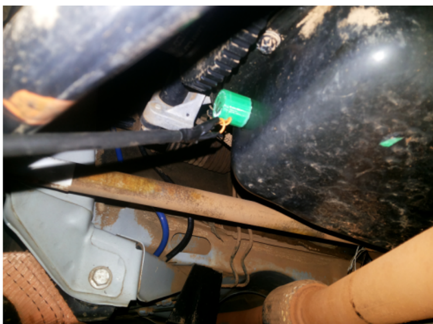
Figura 6 – Posição do acelerômetro no caminho associado ao motor. (ANÁLISE OPERACIONAL DOS CAMINHOS DE TRANSFERÊNCIA APLICADA NA MEDIÇÃO DO NÍVEL DE RUÍDO EMITIDO POR VEÍCULOS AUTOMOTORES, 2015)
