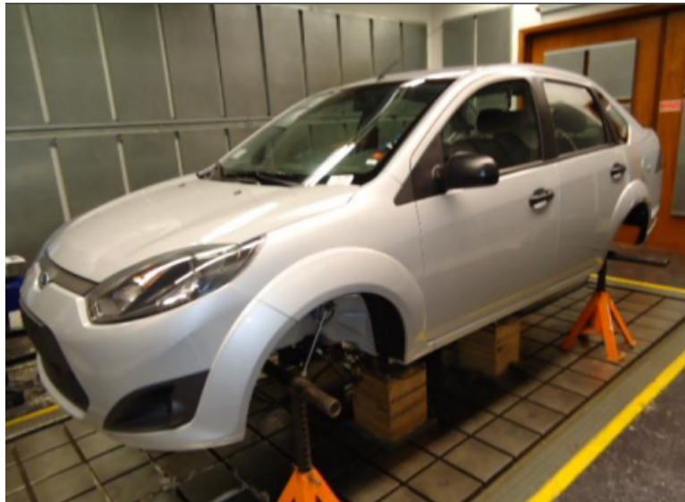
Figura 24 – Medições que antecedem as medições de FRFs em um veículo (Estudo do ruído de rolagem estrutural através da análise dos caminhos de transferência de energia - TPA, 2011).
