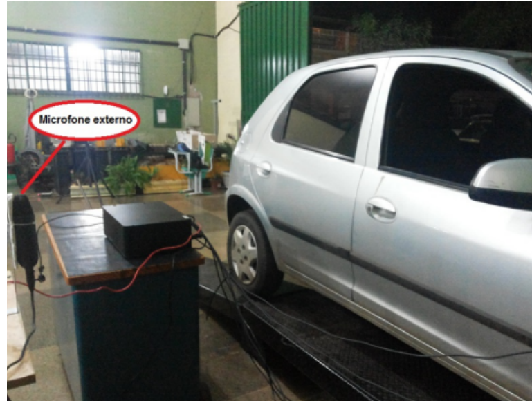
Figura 25 – Posição do microfone externo ao veículo para as medições realizadas na pesquisa (ANÁLISE OPERACIONAL DOS CAMINHOS DE TRANSFERÊNCIA APLICADA NA MEDIÇÃO DO NÍVEL DE RUÍDO EMITIDO POR VEÍCULOS AUTOMOTORES, 2015).
