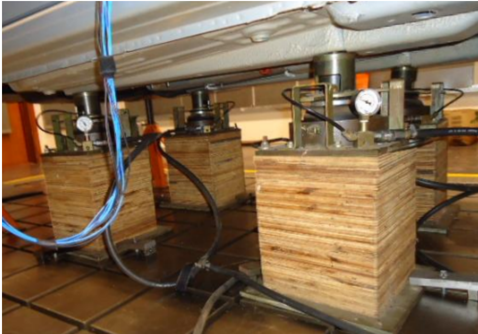
Figura 7 – Shaker sendo representado por colchões de ar.(Estudo do ruído de rolagem estrutural através da análise dos caminhos de transferência de energia - TPA, 2011)
