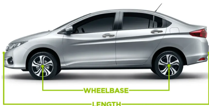
Figura 6 – Entre eixos ( Wheel base ) e comprimento total ( Length )
