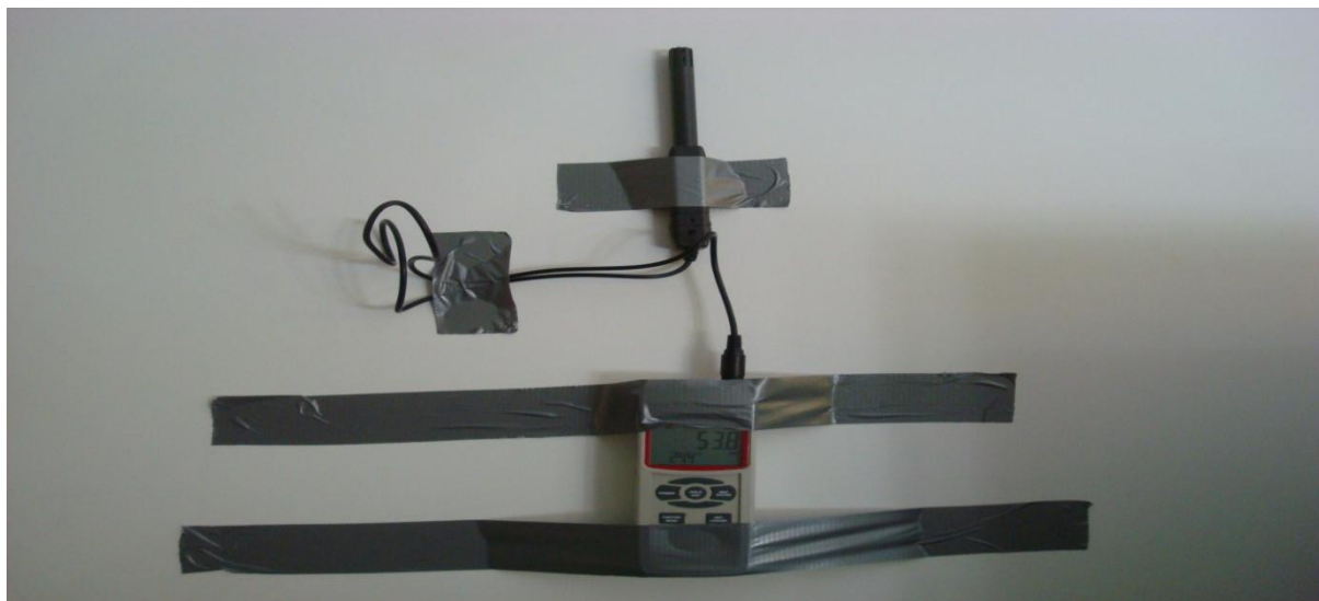
Figura 5.13 - Medição de dados com o termo - higrômetro no prédio do Beijódromo.
