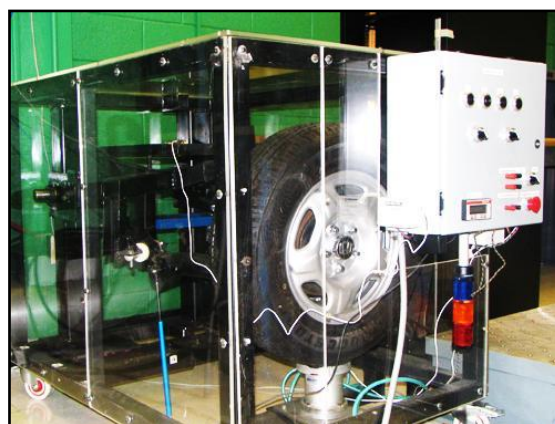
Figura 1.2 – Dispositiva de teste de suspensão montada separadamente. Fonte: www.forfiestaclub.com
