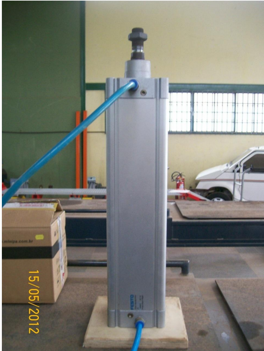
Figura 6.7 – Cilindro pneumático montado para ensaio
