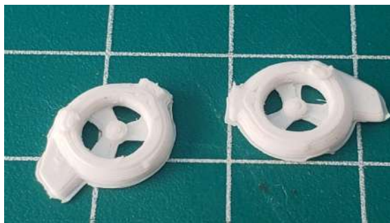
Figura 34 - Resultado da impressão das hélices.
