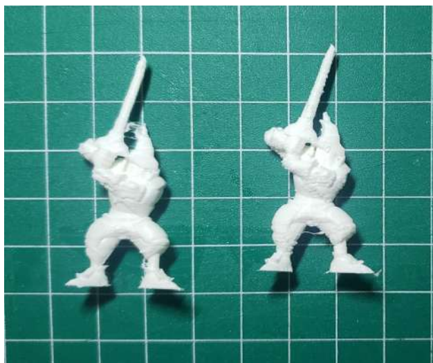
Figura 18 - Resultados da Prusa MK3S de bico 0.4 (esquerda) e Ender 3 de Bico 0.4 (direita)
