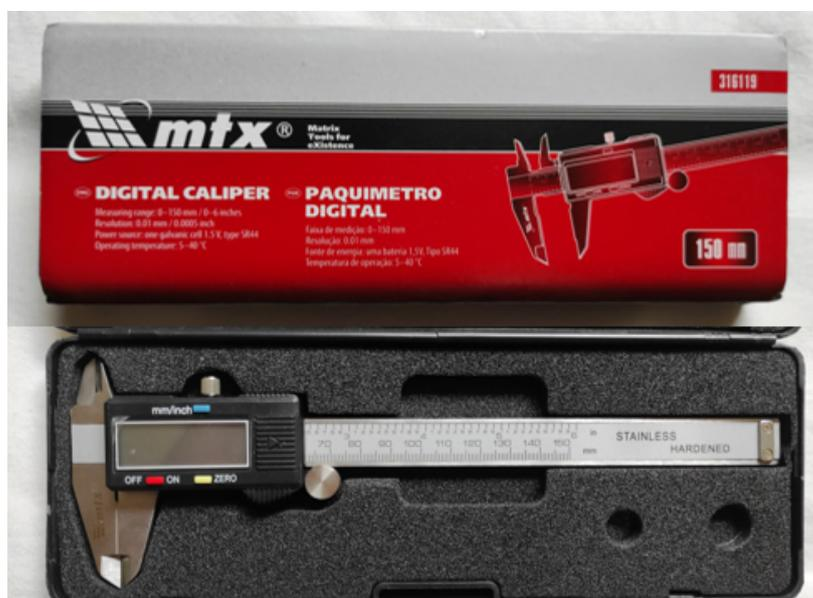
Figura 1 - Paquímetro digital milimetrado (MTX, Brasil, faixa de medição de 0 a 150 milímetros)
