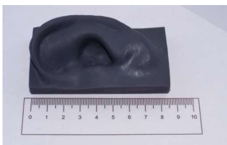
Figura 6 - Modelo de orelha, impresso em impressora 3D (Phrozen Sonic Mini, Phrozen Technology, Taiwan) com resina (Quanton Iron Grey, Quanton 3D, Brasil).
