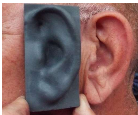
Figura 4 - Modelo em resina (Quanton Iron Grey, Quanton 3D, Brasil) lado a lado com a orelha utilizada para a obtenção das imagens, visão lateral
