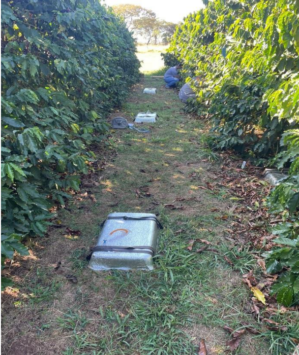
Figura 6. Coleta de gases no sistema de café arábica irrigado, por meio das câmaras estáticas.
