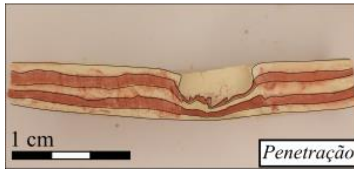
Figura 6.5. Deformação de penetração para o experimento de iniciação científica para a espessura de 30 cm de lâmina de água doce.
