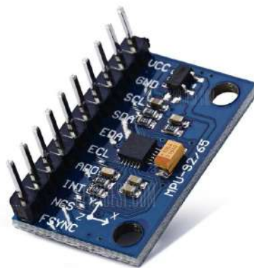
Figura 2.1: Placa que facilita o uso MPU-9250 que oferece, acelerômetro, giroscópio e magnetômetro, todos com 3 eixos. [21]
