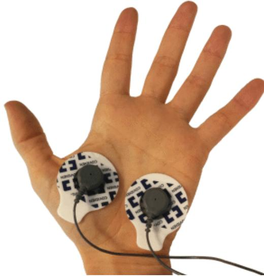
Figura 4.4: Posicionamento dos eletrodos para coleta da EDA com o BITalino [6].
