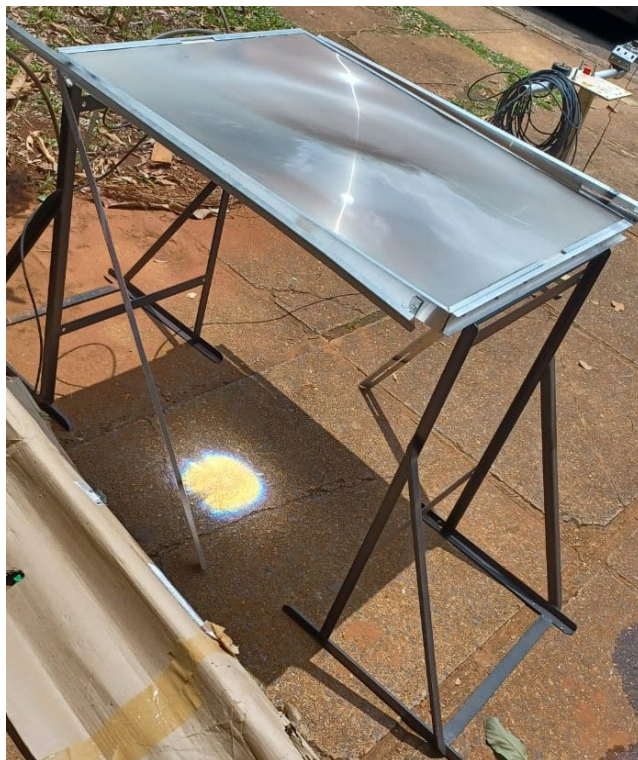
Figura 5. 10 - Concentração solar proporcionada pela lente Fresnel às 11:43 do dia 29/11/2023.
