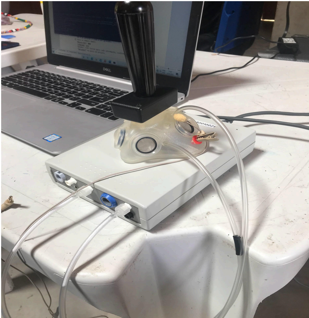
Equipamento Eletroglotógrafo EGG-D800 e computador com alimentação via porta USB. Foto: Lucas Tomaz
