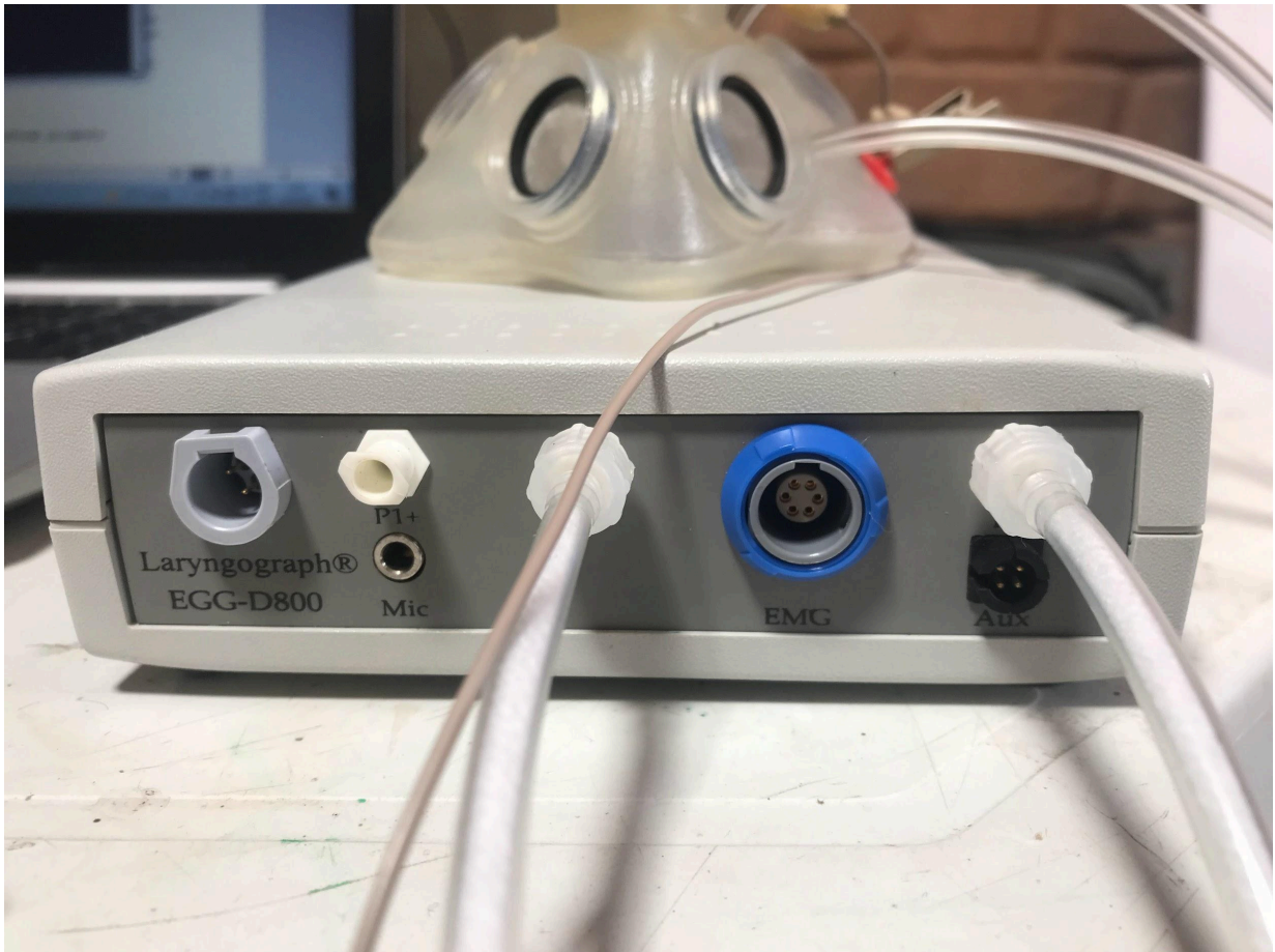
Equipamento Eletroglotógrafo EGG-D800 e máscara facial usada na coleta do fluxo de ar nasal. Foto: Lucas Tomaz
