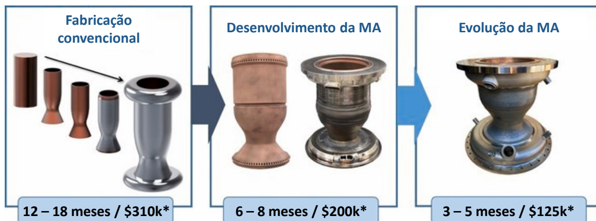
Figura 4 Comparação da fabricação convencional com a MA (custo em US$, equivalente a 2020, créditos da NASA) (adaptado de KERSTENS; CERVONE; GRADL, 2021).
