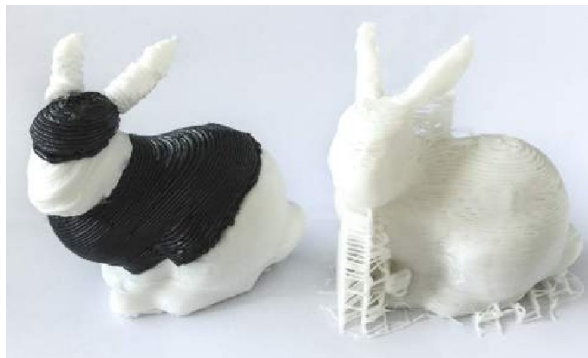
Figura 7 Modelo de um coelho fabricado pelo RoboFDM (esquerda) e modelo fabricado por FDM convencional (direita) (WU et al., 2017).
