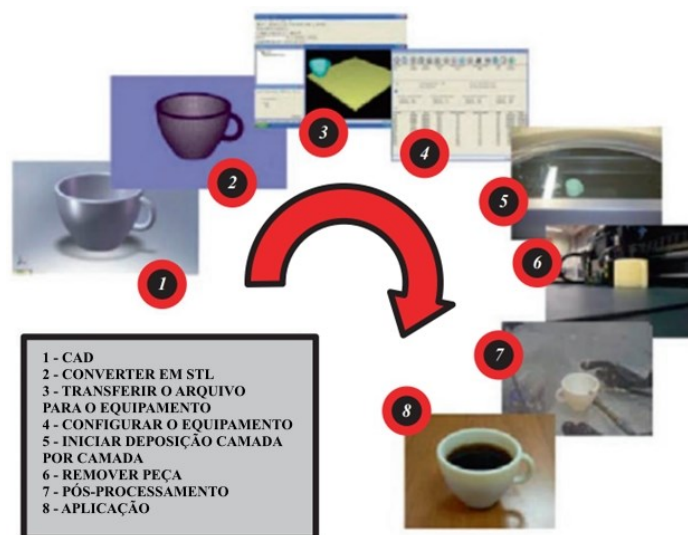
Figura 2 Etapas de fabricação de uma peça por MA (adaptado de GIBSON et al., 2021).
