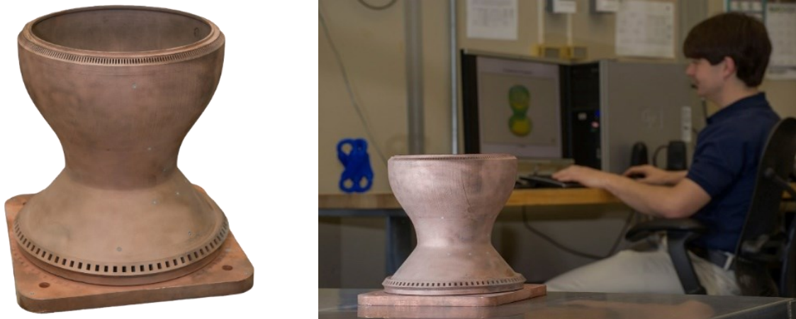
Figura 17 Câmara de combustão fabricada por SLM, a varredura de luz vista na tela do computador, ajudou a verificar se a peça foi construída conforme projetada, créditos da NASA/MSFC/Emmett Given (adaptado de HARBAUGH, 2015).
