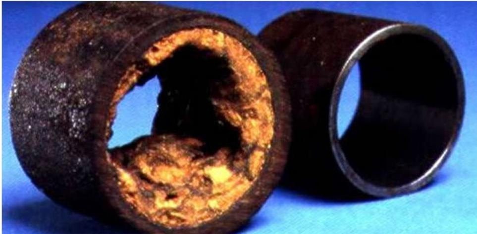
Figura 1.2: Comparação de dutos com e sem incrustações. Retirado de [Penafiel \(2020\)](#).
