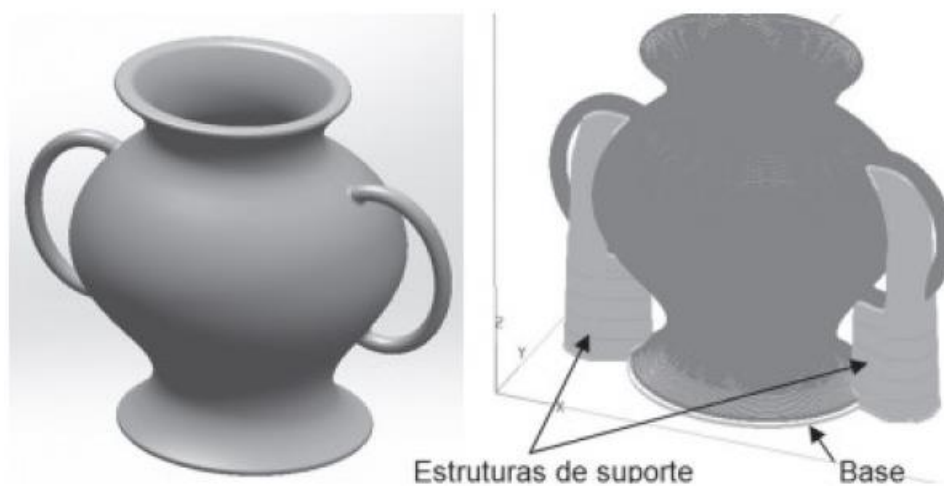
Figura 10 - Exemplo da utilização de estruturas de suporte – Adaptado de Volpato (2007)
