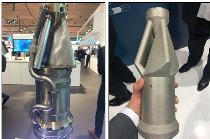
Figura 19 – Combustores produzidos por manufatura convencional na esquerda e MA na direita (ARC ADVISORY GROUP, 2018)
