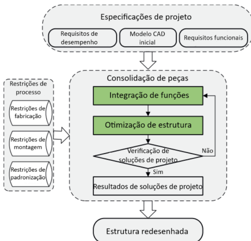
Figura 22 - Metodologia de processo para consolidação de componentes – Adaptado Yang, Tang e Zhao (2015)
