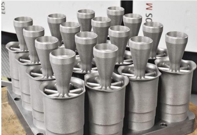
Figura 18 – Turbilhonadores produzidos pela Siemens (AMFG, 2020)
