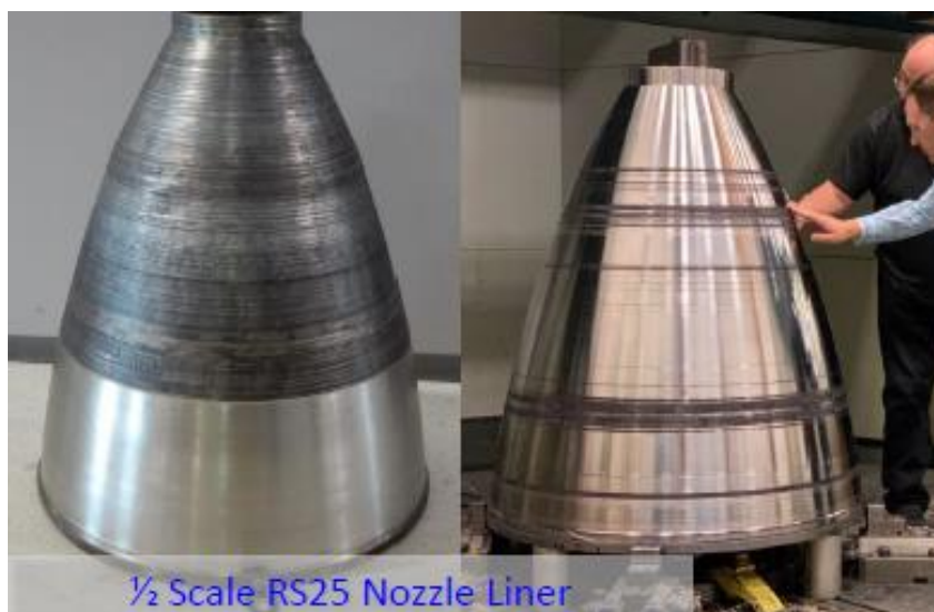
Figura 15 - Um bocal de foguete fabricado no processo DED para aplicações aeroespaciais (GRADL, 2021)
