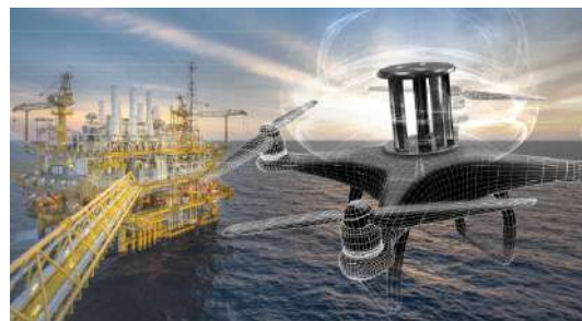
(b) Idealização de um drone de inspeção de alta estabilidade utilizando rotores convencionais e um ciclorotor
