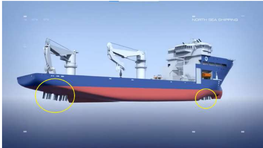
(a) O sistema de propulsão na dianteira e traseiro do navio de construção offshore, indicados pelos círculos amarelos. Retirado de GROUP (2019) .
