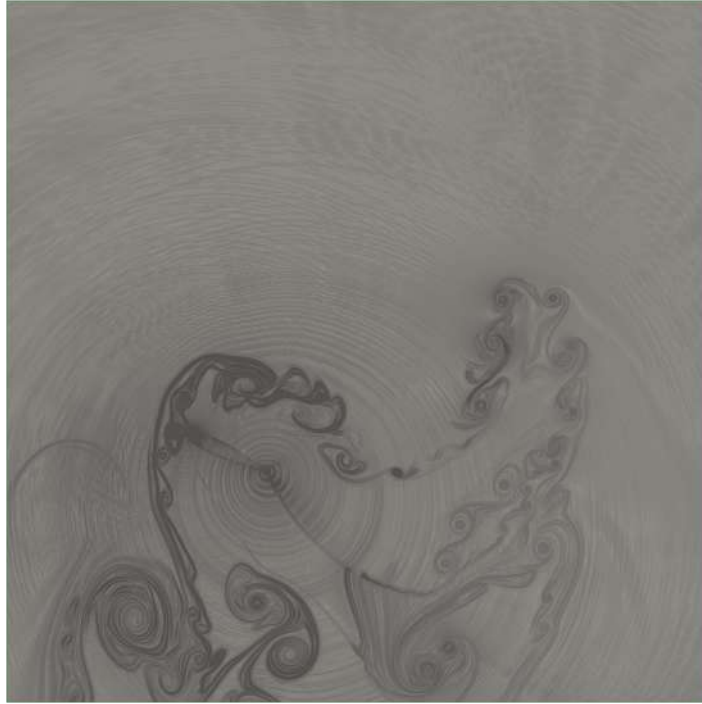
Figura 5.10: Visualização do escoamento de um ciclorotor de uma pá com \phi_0 = 0,20 e m = 0,8
