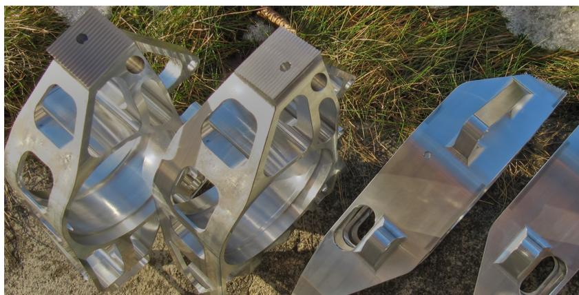
Figura 36: Manga de eixo usinada em liga de alumínio com alívios em diferentes eixos da equipe MunicHMotorsport da *Formula Student* na Alemanha.
