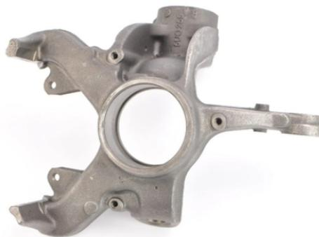
Figura 31: Manga de eixo em ferro fundido de um carro de passeio.
