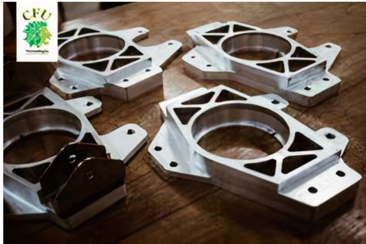
Figura 35: Manga de eixo usinada em liga de alumínio para o protótipo *AF15* da Apuama Racing.
