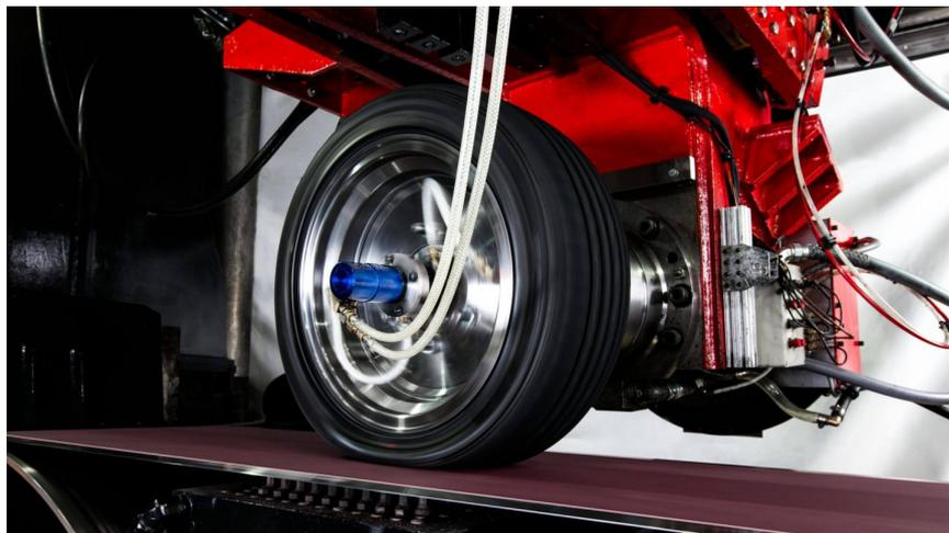
Figura 62: Máquina de testes TIRF da Calspan em operação (CALSPAN, 20118).
