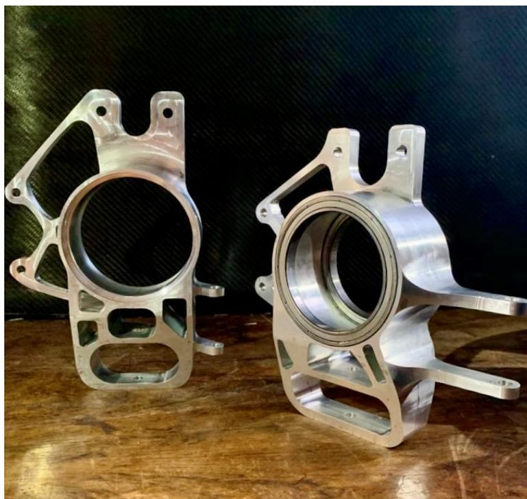
Figura 106: Mangas de eixo dianteira e traseira manufaturadas para o protótipo AF19.
