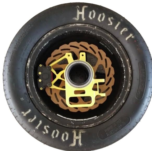
Figura 82: Manga de eixo dianteira manufaturada em impressão 3D.
