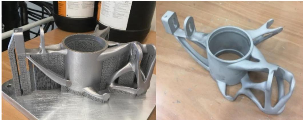
Figura 43: Manga de eixo de liga de alumínio concebida por manufatura aditiva (HUNAR et al., 2020).
