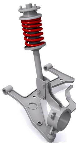
Figura 4: Suspensão Mcpherson.
