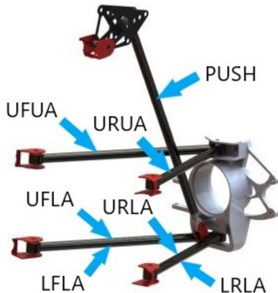
Figura 89: Nomenclatura dos extensômetros nas bandejas superior e inferior, e na vara de compressão na suspensão dianteira direita do protótipo.
