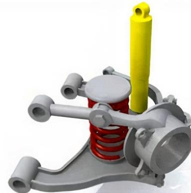
Figura 6: Suspensão multibraços.
