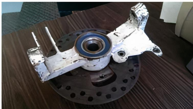
Figura 34: Manga de eixo de elementos tubulares unidos a um núcleo cilíndrico do protótipo AF14 da Apuama Racing.
