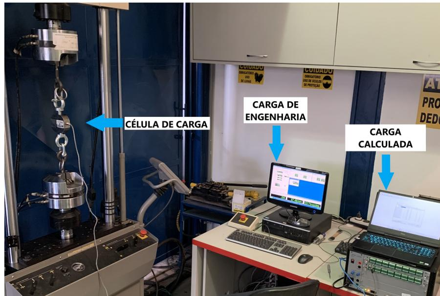
Figura 85: Montagem do aparato experimental para calibração da célula de carga.
