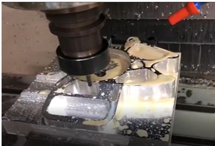
Figura 83: Manga de eixo dianteira em processo de usinagem.
