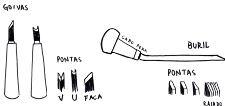
Figura 17 - ferramentas de gravar
