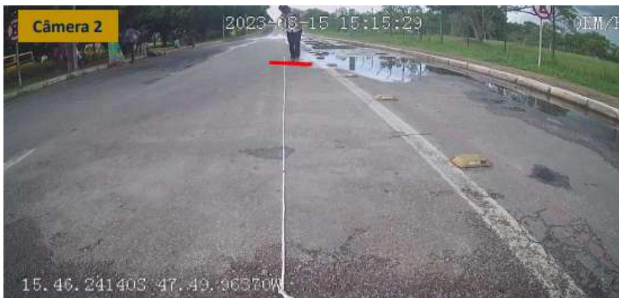
Figura 4.20: Teste da distância de captura máxima da câmera de pavimentos, onde a linha vermelha representa a distância de 8 metros
