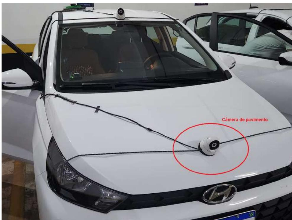
Figura 4.1: Carro de pesquisa, com as duas câmeras utilizadas. A câmera responsável pela captura das imagens de pavimento está destacada em vermelha, localizada no capô do veículo
