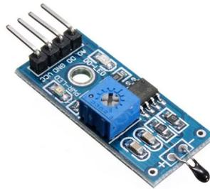
Figura 2.3: Sensor de temperatura NTC (Fonte: [24])
