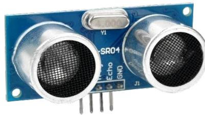
Figura 2.5: Sensor Ultrassônico modelo - HC-SR04 (Fonte: [30])
