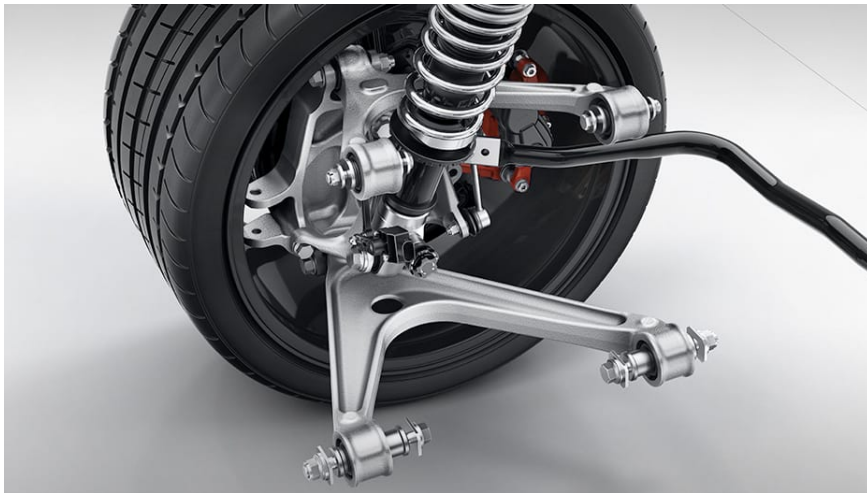
Figura 3.16: Geometria Duplo A, Fonte: CARBLOGINDIA (2020).
