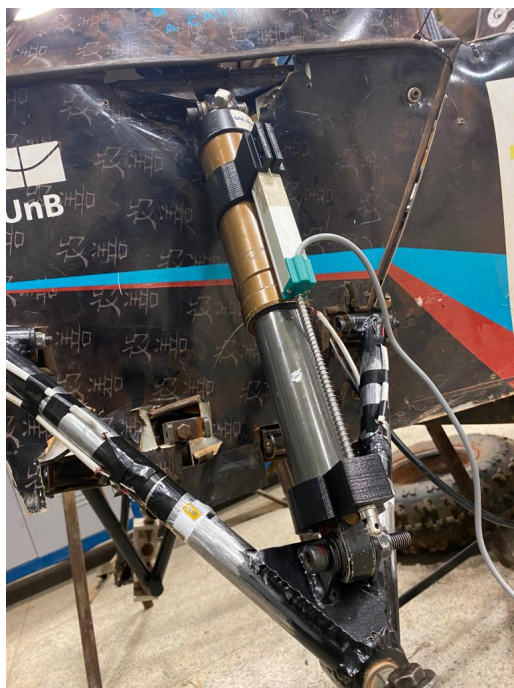
Figura 4.8: Transdutor de deslocamento no amortecedor dianteiro esquerdo, Fonte: De autoria própria.
