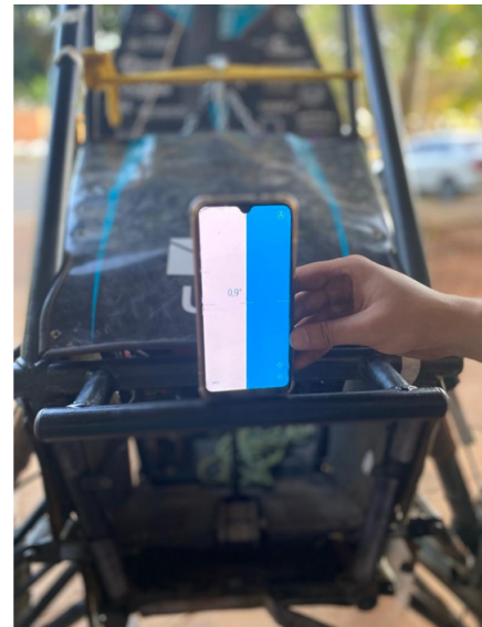
Figura 4.18: Regulagem de ângulo, Fonte: De autoria própria.
