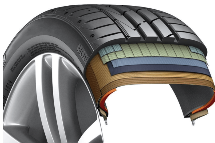
Figura 3.1: Características construtivas de um pneu, Fonte: ECOFLEXPNEUS (2023).
