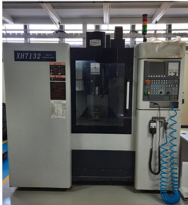
Figura 26 – Centro de usinagem vertical VEGA XH7132
