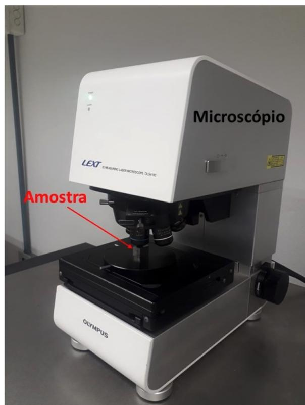
Figura 32 – Microscópio utilizado no experimento para levantamento das variáveis de saída (SILVA, 2021).
