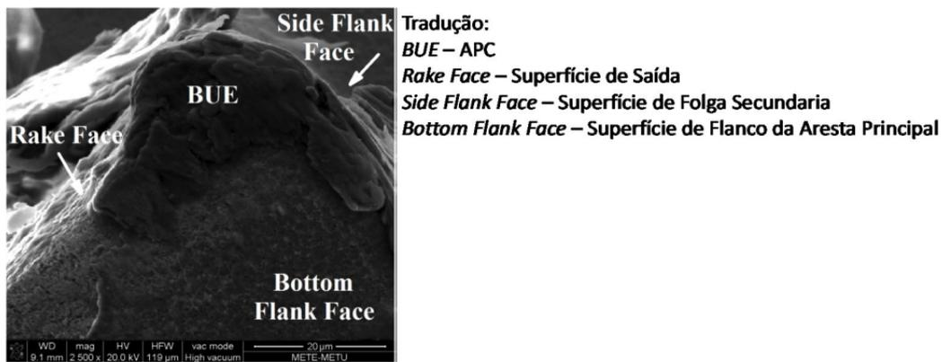
Figura 44 – Ponta da microfresa com APC (Adaptado de Oliaei e Karpát (2017)).
