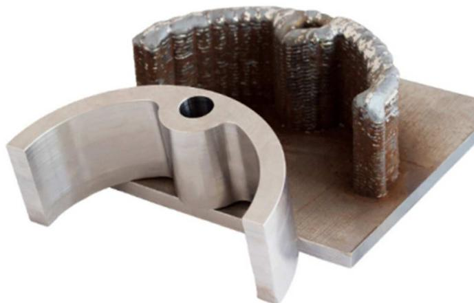
Figura 4: Resultados da usinagem em uma peça fabricada por manufatura aditiva. Adaptado de Decapaggio (2020).
