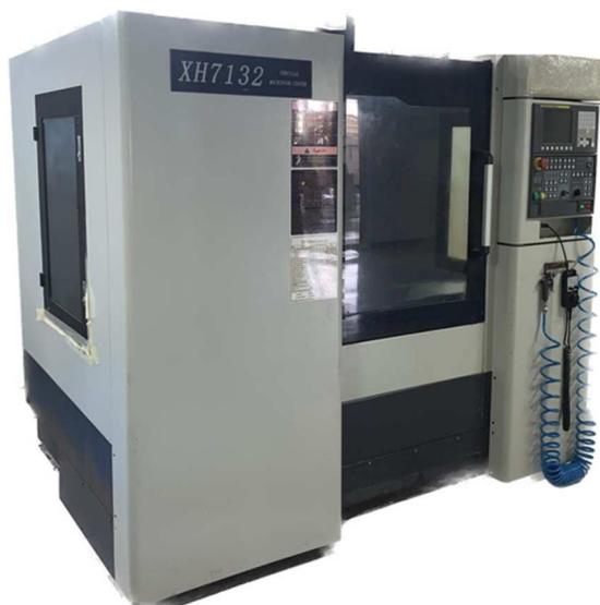
Figura 43: Máquina de usinagem vertical VEGA XH7132.
