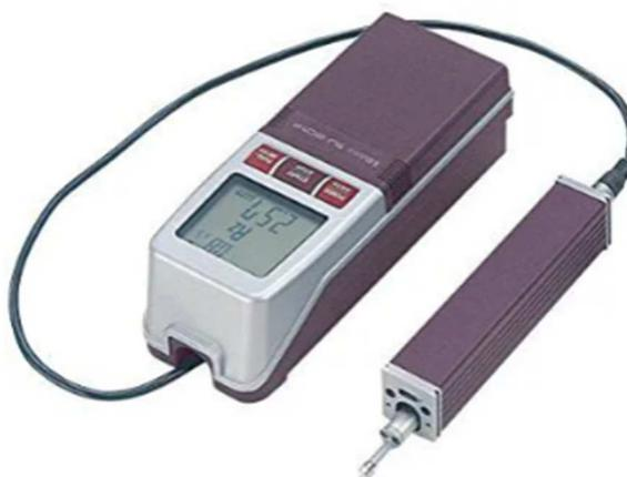
Figura 51: – Rugosímetro modelo SJ-201 da Mitutoyo (SEG, 2022).
