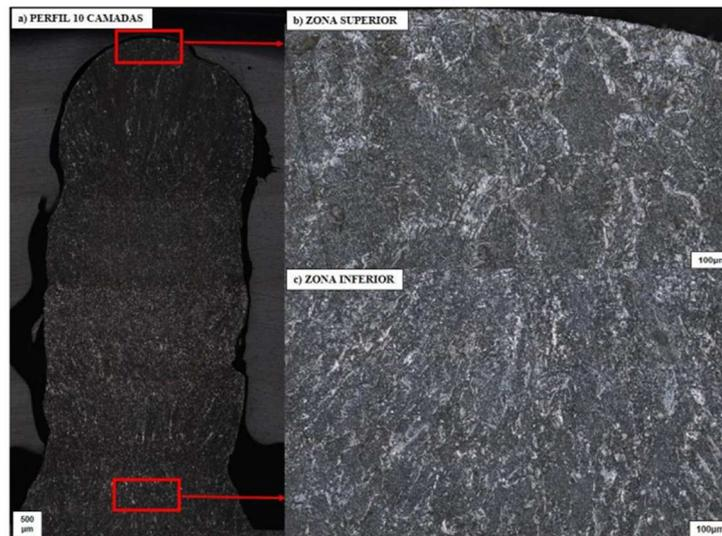
Figura 32: Microestrutura da primeira amostra com lente 50x (OLIVEIRA,2022).
