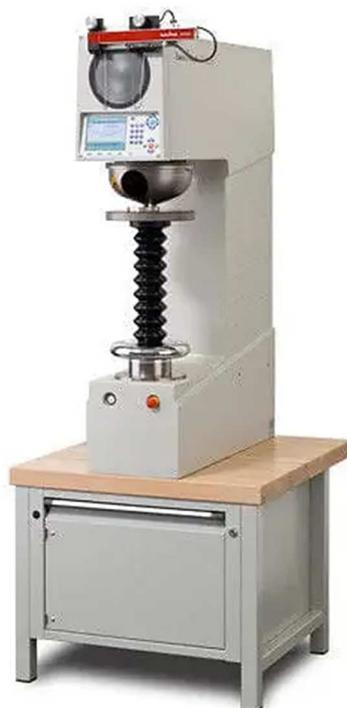
Figura 53: Durômetro Zwick Roell ZHU250 (ZWICK, 2023).
