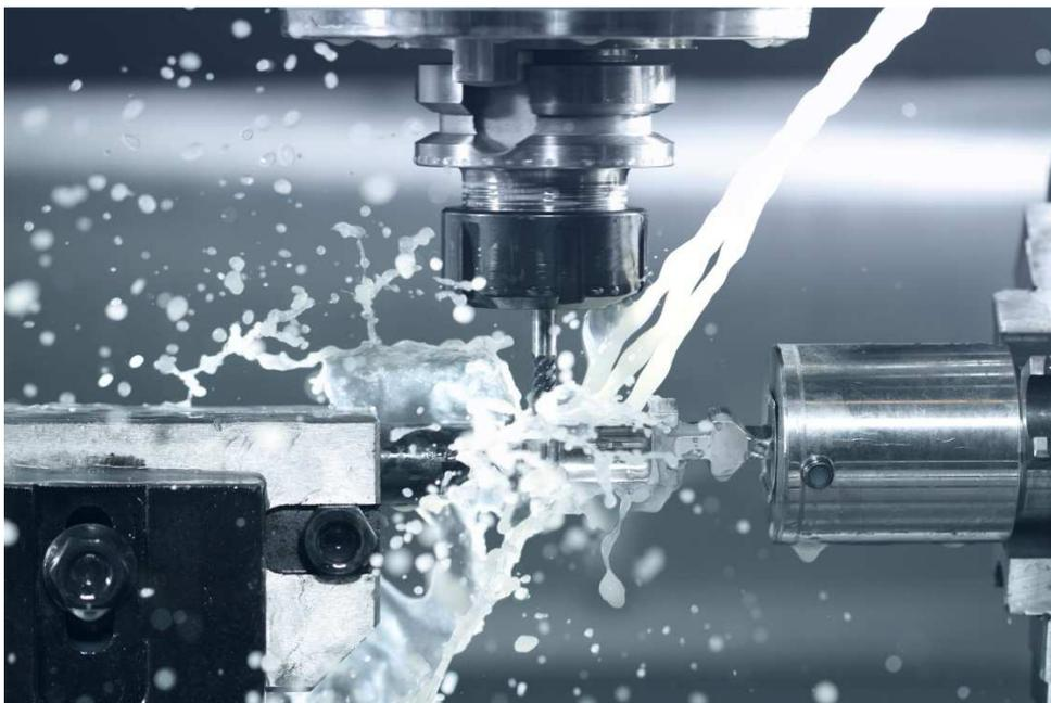
Figura 15: Aplicação do fluido de corte no processo de usinagem (RUDNIK, 2008).
