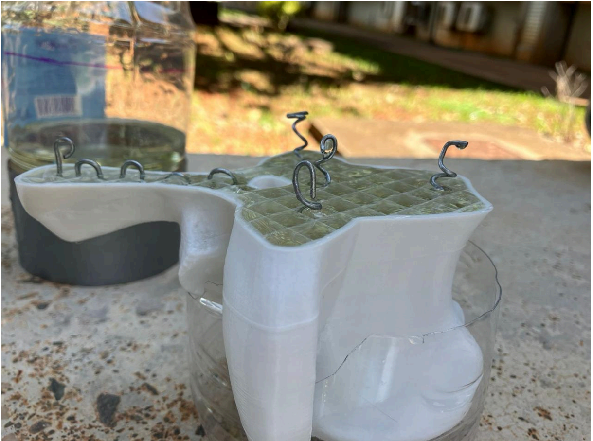
Figura 7 – Teste com resina, areia lavada e arames para fixação.
