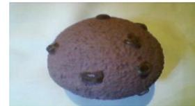
Figura 5. Foto que retrata o protótipo, esfera feita de massa de cimento.
