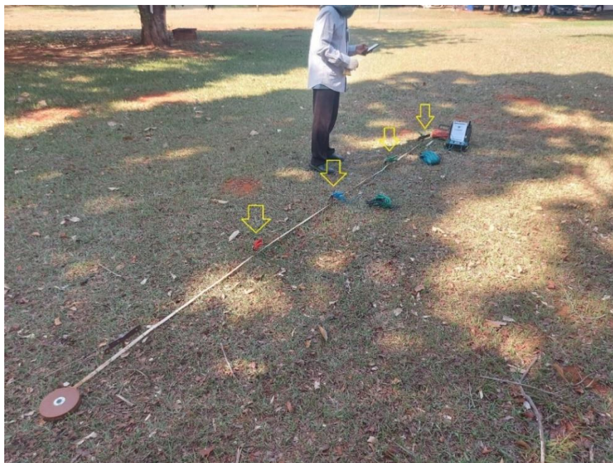
Figura 6.5 – Momento da implementação do método de Wenner
