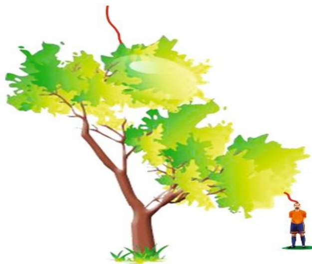
Figura 2.12 - Ilustração de uma pessoa sendo atingida por um descarga elétrica lateral oriunda de uma árvore que está sendo atingida por uma descarga atmosférica. [14]
