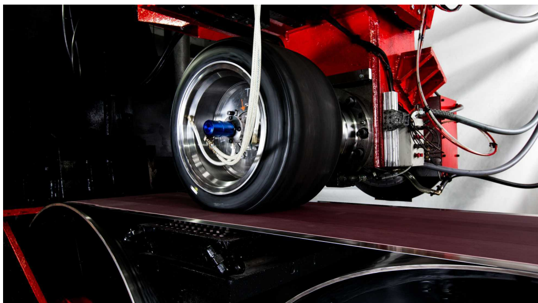
Figura 12 – Teste em bancada para aquisição de dados de interação entre pneu e solo, o TTC. ( https://www.calspan.com/services/transportation-testing-research-equipment/tire-performance-testing/motorsports-tire-testing/ )
