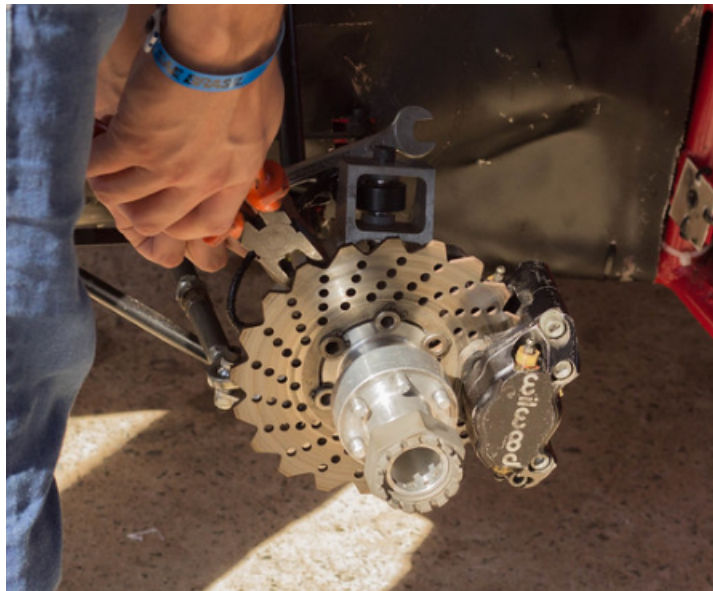
Figura 7 – Cubo do tipo rápido e com disco flutuante em protótipo de equipe de FSAE. (Acervo pessoal.)
