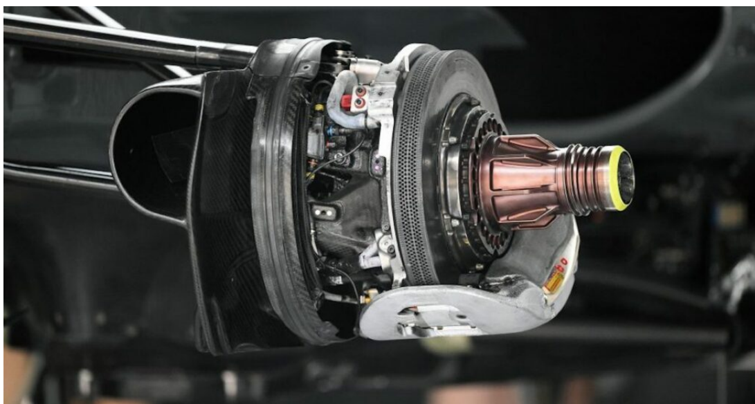
Figura 5 – Detalhe para o conjunto de massa não suspensa de um carro de Fórmula 1. ( http://www.safebraking.com/hass-f1-brake-disc-explodes/ )
