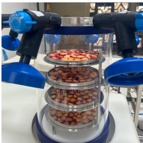
Figura 3- Batelada de acerolas sendo liofilizadas.
