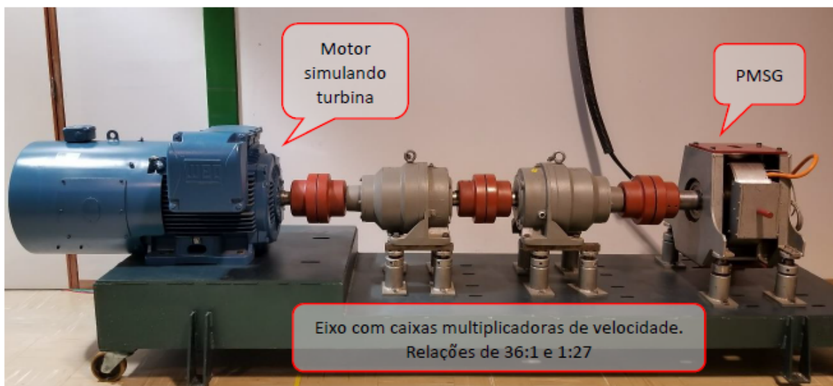
Figura 8 – Conjunto eletromecânico, constituído por MIT, acoplamentos e PMSG, existentes no LQEE (Oliveira, 2018).
