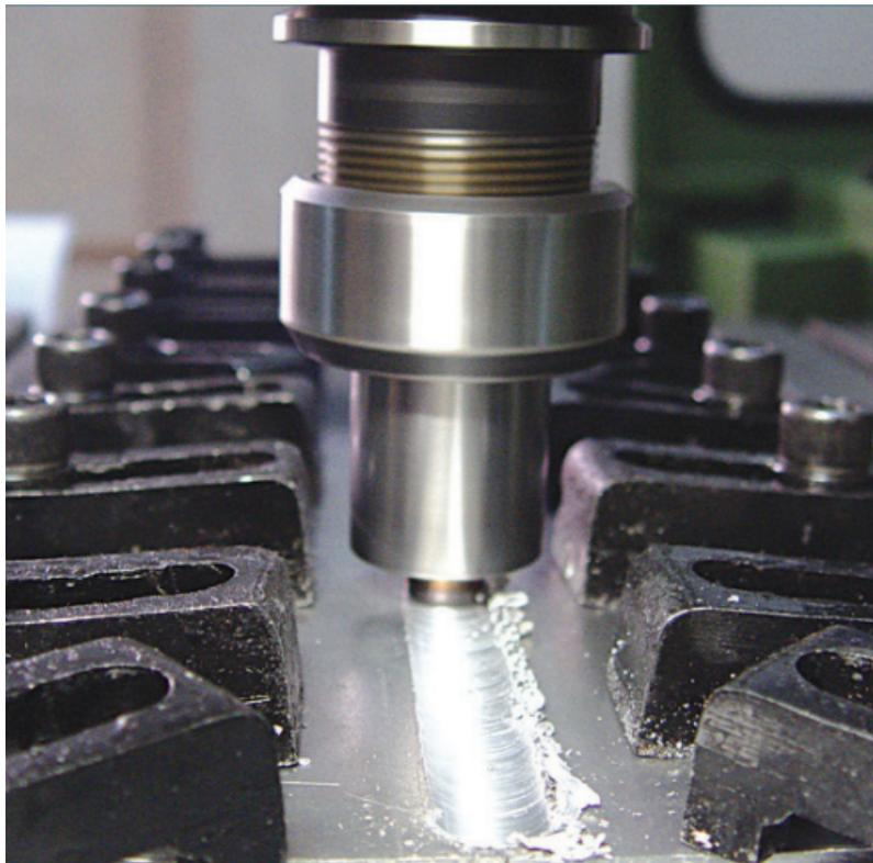
Figura I.1: Detalhe de uma soldagem FSW (Asadi et al. 2014)
