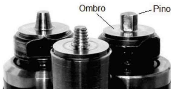
Figura 3.2: - Ferramentas do processo FSW (Capelari e Mazzaferro (2009), modificada).
