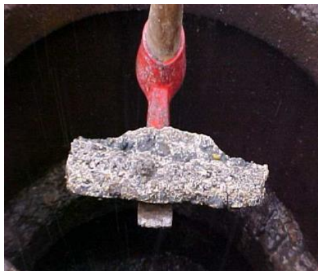
Figura 4 - “Bucha”: massa rígida causada pela aglutinação de óleo residual descartado e outros materiais.
