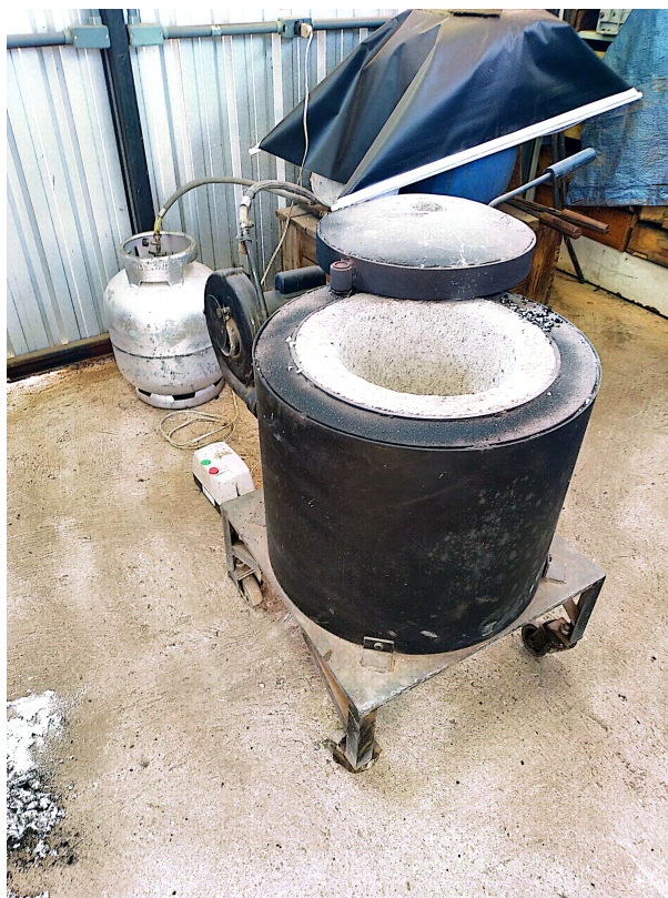
Figura 22 – Forno a gás utilizado para derreter o alumínio
