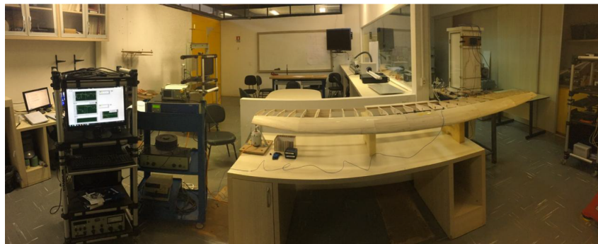
Figura 48 – Montagem do GVT da asa de 2019
