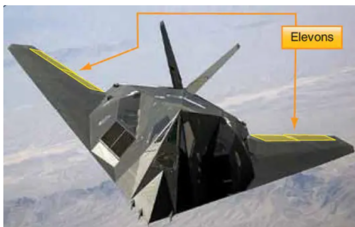
Figura 11 – Lockheed F-117 com seus elevons destacados. Fonte: < https://www.flight-mechanic.com/flight-control-surfaces-part-two/ >, acessado em 21/08/2021
