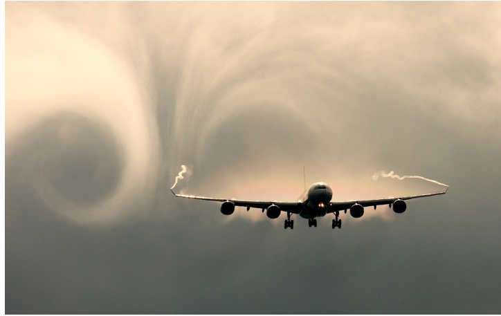
Figura 10 – Vórtices de ponta de asa em um Airbus A340. Fonte: < https://i.imgur.com/siXhY0l.jpg >, acessado em 21/08/2021
