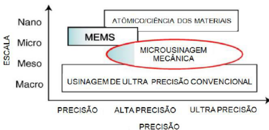
Figura 2 – Precisão do processo de microusinagem. Adaptado de Chae, Park e Freiheit (2006).
