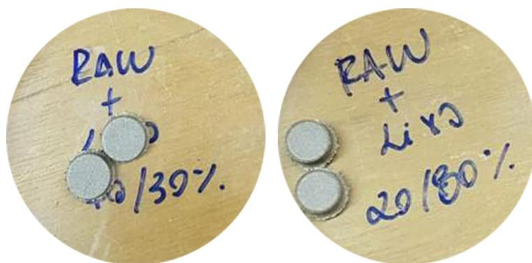
Figura 4.1: Biocombustível híbrido de biomassa in natura e RSU.
