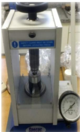
Figura 3.4: Equipamento de fabricação de *pellets*
