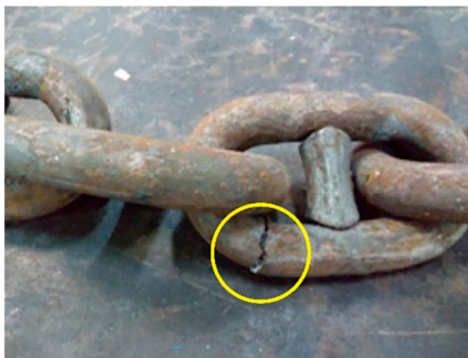
Figura 1.5: Falha típica por fadiga observada experimentalmente (MAMIYA et al., 2019).
