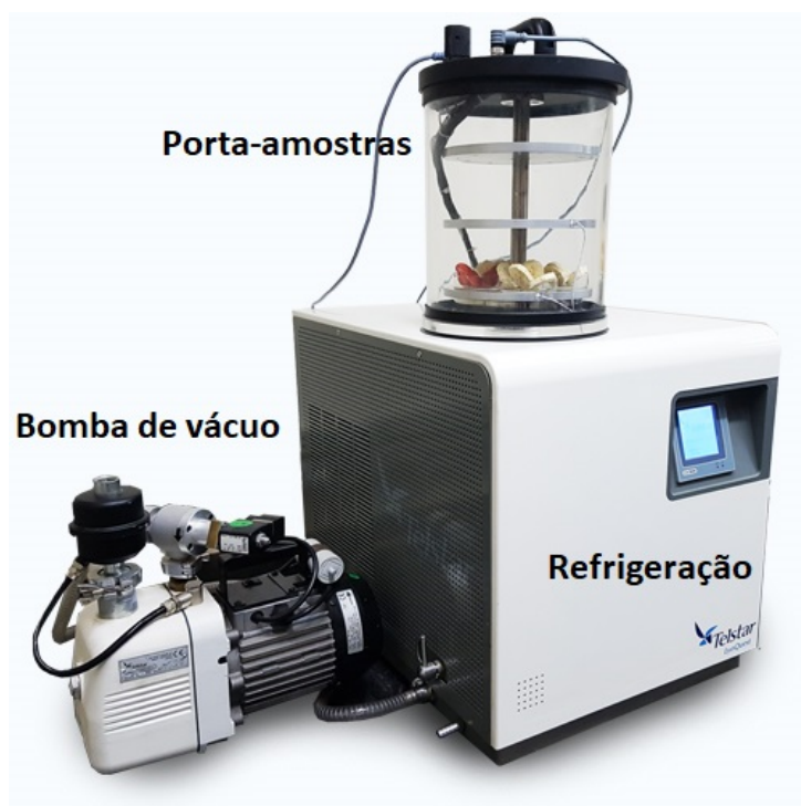
Figura 22 – Exemplo de um liofilizador com componentes principais identificados.
