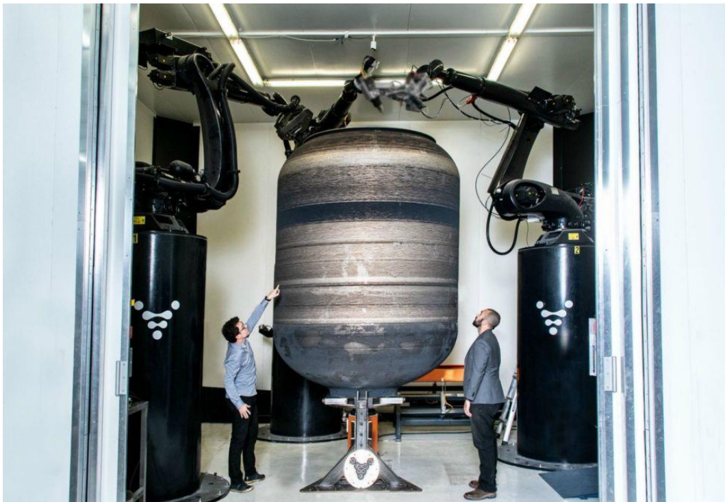
Figura 4 Stargate na fabricação do tanque de combustível em alumínio para o Terran 1 (Relativity Space apud ARS TECHNICA, 2019)
