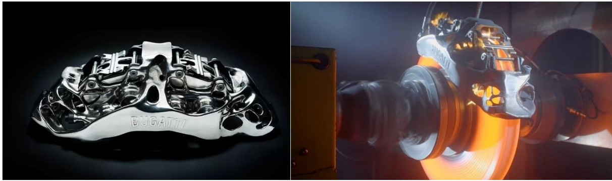
Figura 2 Pinça de freio de titânio projetada e produzida por manufatura aditiva (BUGATTI automotive, 2018)
