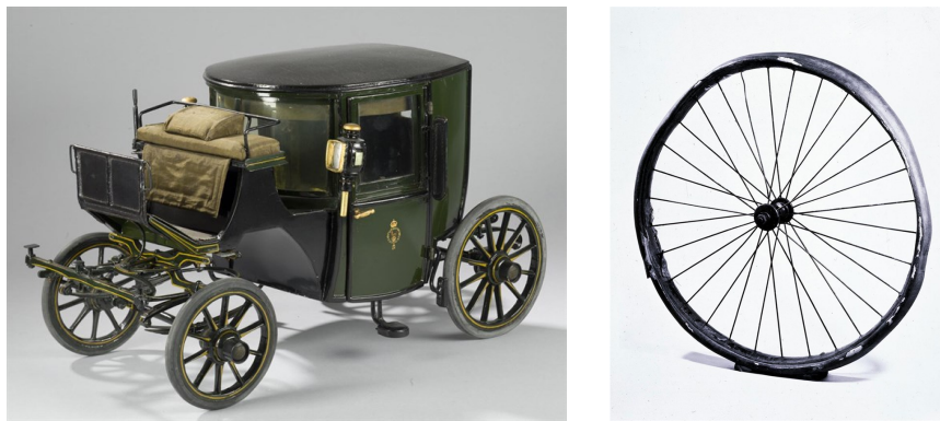
Figura 1.2: (a) Primeira carruagem com pneus (Thompson 1847) (b) Primeiro pneu e roda de Dunlop (J.B.Dunlop 1887).
