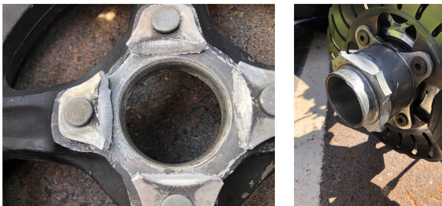
Figura 1.9: Falha estrutural no cubo de roda do protótipo AF18 em 2019.
