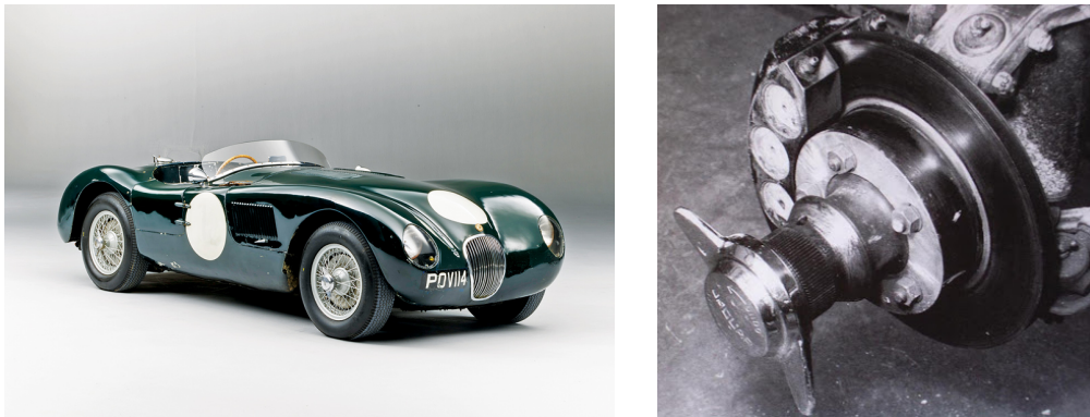
Figura 1.5: Jaguar C-Type 1953 e detalhe do seu sistema de freios.
