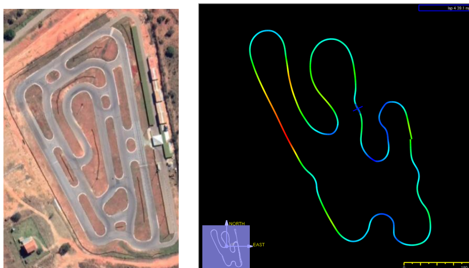
Figura 3.5: (a) Foto do circuito Bsb Kart (b) Mapa gerado com GPS e colorido de acordo com velocidades desenvolvidas.
