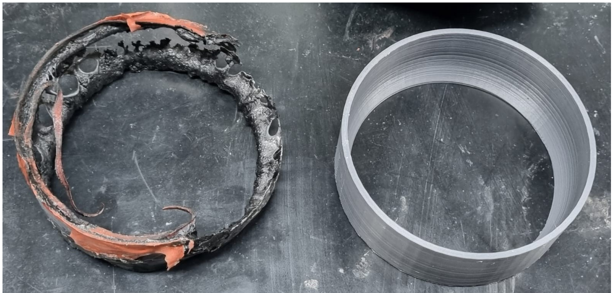
Figura 64 – Deterioração da peça 3D da pré-câmara de combustão
