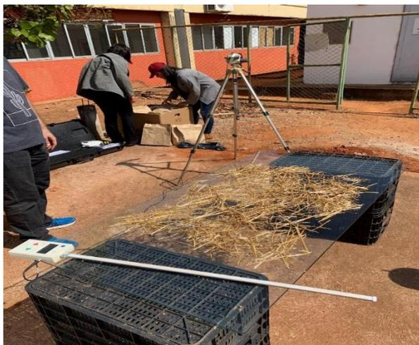
**Figura 2.** Início da sobreposição da palhada, para a determinação do coeficiente de extinção da radiação solar.
