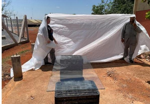
**Figura 4.** Foto do experimento com a lona esticada para funcionar como quebra vento.
