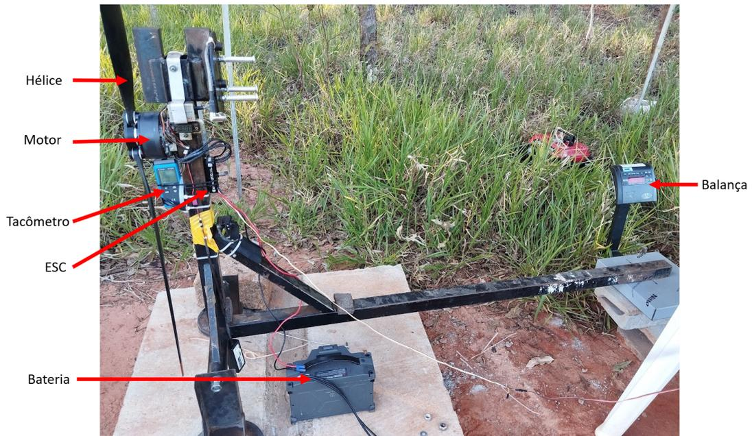
Figura 37 – Elementos do ensaio de tração
