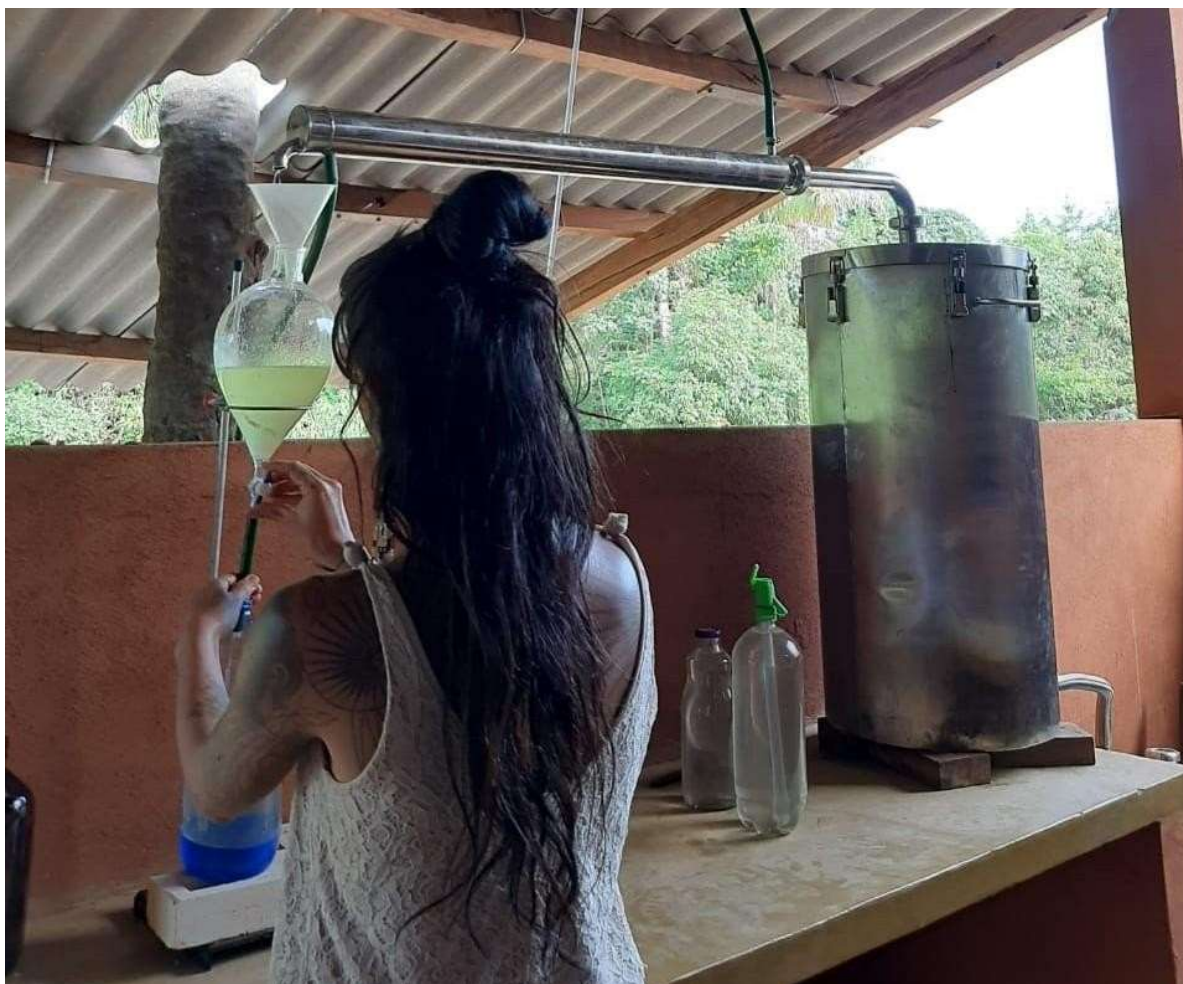
Figura 21: Destilação por arraste a vapor de Eucalyptus globulus .
