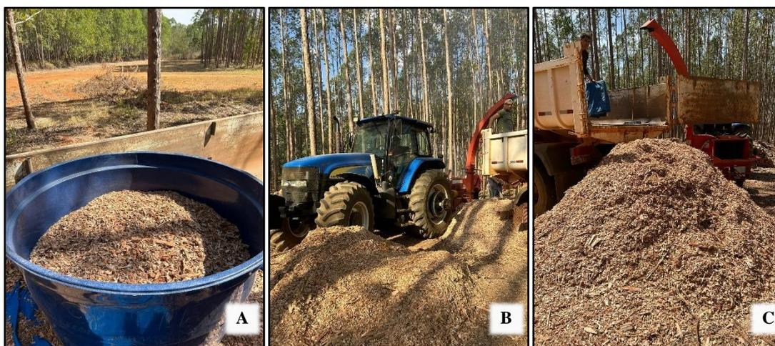
**Figura 7.** Cavaqueamento da madeira. a) utilização da caixa para medir  $1\text{m}^3$  de cavaco; b) trator com o picador acoplado; c) pilha de cavaco.
