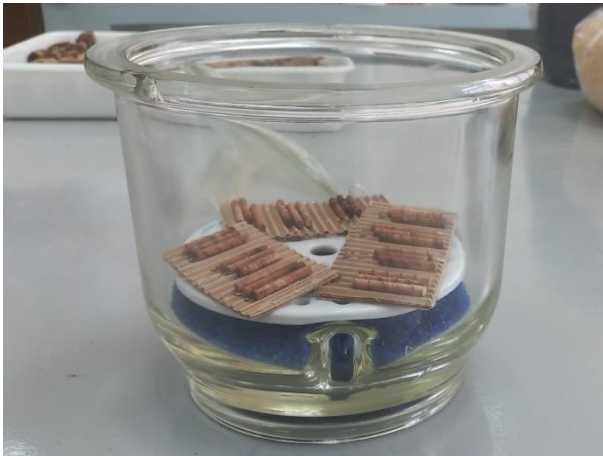
Figura 22: Após 24 horas, as amostras foram transferidas para um dessecador a vácuo.
