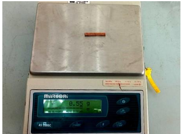
Figura 23: Obtenção da massa seca das amostras.
