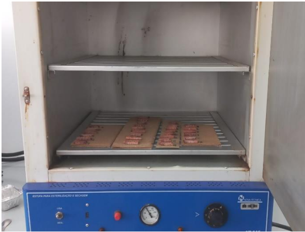
Figura 20: Amostras posicionadas na estufa para o início do processo de secagem.
