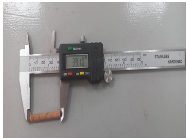
Figura 19: Medição do comprimento e diâmetro das amostras, após período de saturação.
