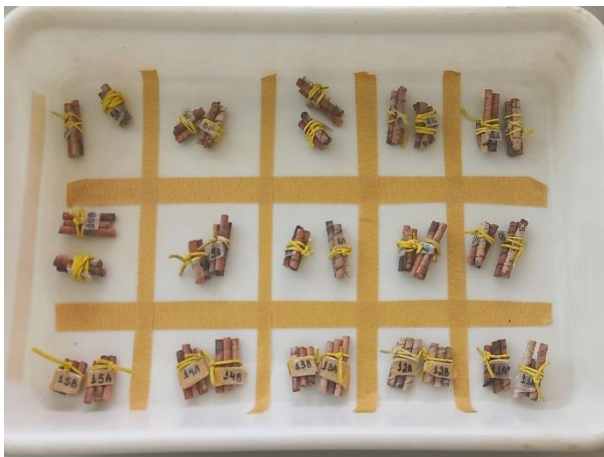
Figura 16: Amostras colocadas em um recipiente para submersão.
