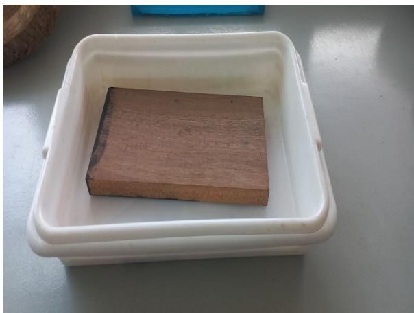
Figura 18: Peso colocado sobre as amostras para garantir que fiquem completamente submersas.
