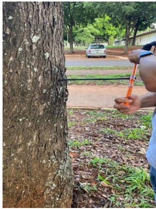
Figura 5: Posicionamento da sonda em ângulo reto em relação ao tronco da árvore.
