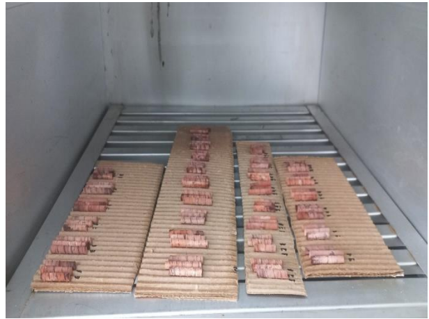
Figura 21: Amostras dispostas na estufa para iniciar a secagem.
