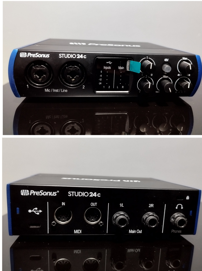
Figura 3.2. Interface de áudio Presonus Studio 24c [4] utilizada para aquisição e reprodução dos sinais de áudio.
