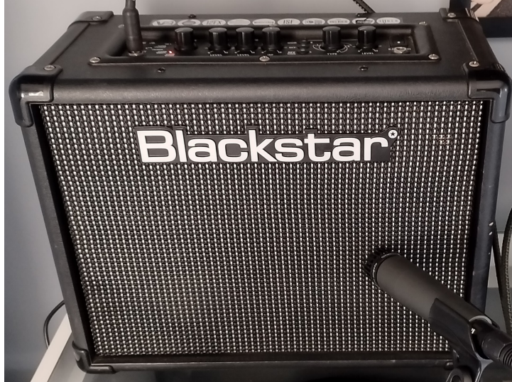
Figura 3.3. Amplificador Blackstar ID Core 20 v2 [5] e microfone dinâmico Santo Angelo SAS 57 [6] utilizados como sistema a ser modelado a partir da introdução de senoides ao amplificador e captura do sinal de saída pelo microfone.
