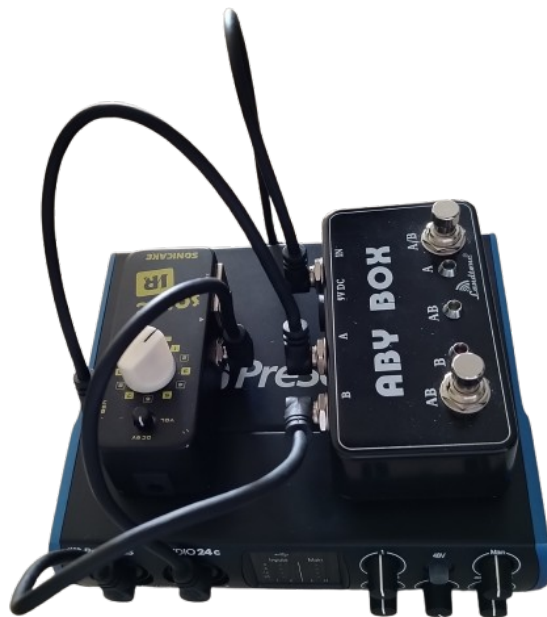
Figura 4.1. Conexões utilizadas para processo de modelagem do pedal Sonic IR. A saída da placa de áudio é conectada ao pedal ABY Box que divide a entrada em duas saídas: um ligada ao canal 1 da placa de áudio e, outra ao pedal Sonic IR. A saída do pedal é ligada no canal 2 da placa de áudio.
