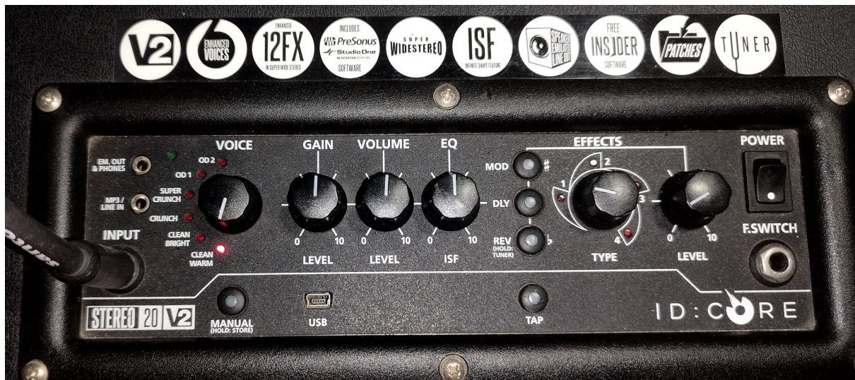
Figura 4.8. Configuração do amplificador Blackstar ID Core 20 v2 para modelagem do canal “Clean Warm”.
