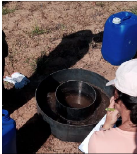
Figura 13 - Teste de Infiltração com anéis concêntricos.
