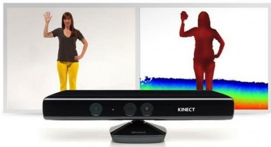
**Figura 2** – Microsoft Kinect comparando a imagem real com a obtida pelo sensor. Fonte: [\[19\]](#)
